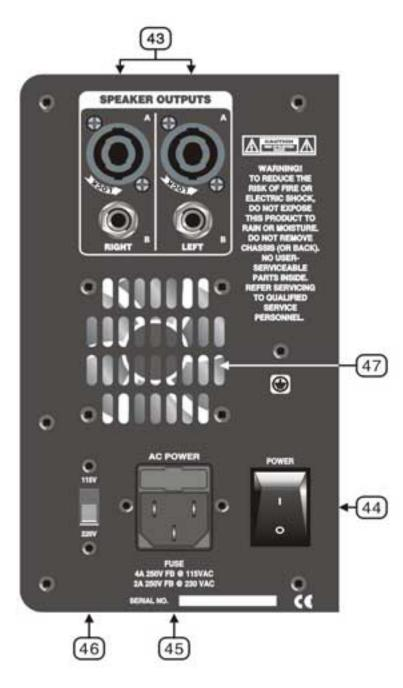
43.SPEAKER JACK(LEFT/RIGHT) This is a amplifier output jack. 8 CHANNEL MIXER:300W+300W 4Ω 10 CHANNEL MIXER:300W+300W 4Ω 12 CHANNEL MIXER:300W+300W 4Ω MONO 12 CHANNEL MIXER:350W 4Ω
